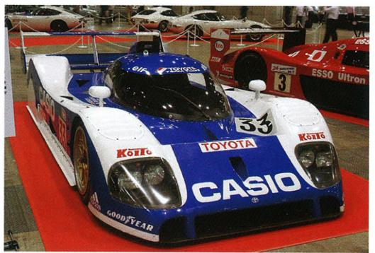
国際スポーツカー選手権(SWC)規定に合わせて、鳩谷氏が開発責任者となって制作されたトヨタTS01。1992年のル・マン24時間レースで総合2位を獲得したマシンだ。エンジンは当時のF1と同じNA3500ccで、レイアウトはV型10気筒。まさにF1にボディカウルが付いたようなマシンで、最高速は400km/hに達する。エンジンへの負荷も大きめだが、当時オイル開発を担当していたエルフとともに、全開5000km無交換で性能を落とさないオイルを作り出した。まさにオイルも重要なエンジンパーツのひとつであることを実証。
