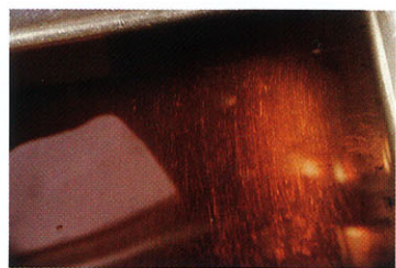
250cc単気筒モデルで1万kmを走破したZZ-01をニューテックで分析すると、若干の粘度低下は認められた。だが酸価、塩基価、金属分析とも問題となるような劣化はなく、充分な許容範囲と判断された。トレイに抜き取ったオイルを光りにかざすと、まだ透明感が残っている。これがシール性の高さによる汚れの少なさ、ということだろう。
