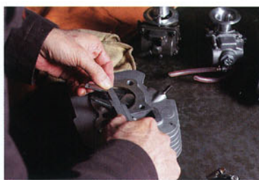
スペシャルヘッドを観察し、ベンチュリー径の小さなキャブなら吸気φ23mm、排気φ18mmのスタンダードヘッドの方がバランスが良いのでは、と鳩谷氏。充填効率アップを狙うなら、吸気バルブの当たり位置を燃焼室の内側に移動して開口面積を絞るのも手だと、興味深い示唆も。
