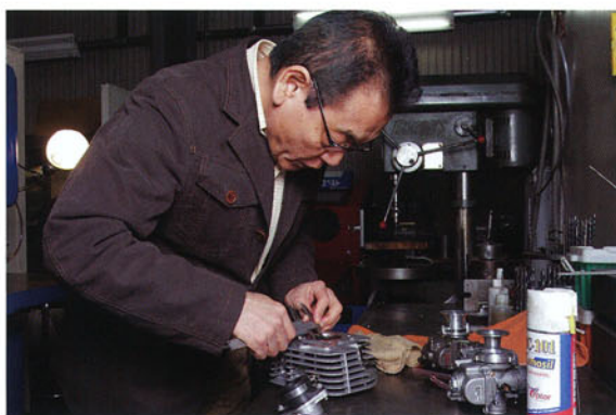
スペシャルヘッドを観察し、ベンチュリー径の小さなキャブなら吸気φ23mm、排気φ18mmのスタンダードヘッドの方がバランスが良いのでは、と鳩谷氏。充填効率アップを狙うなら、吸気バルブの当たり位置を燃焼室の内側に移動して開口面積を絞るのも手だと、興味深い示唆も。
