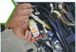
●点火プラグを外し圧縮圧力回復剤を注入。熱に反応して形成されるミクログの膜が、シリンダー表面やピストンリングの透き間を埋める
