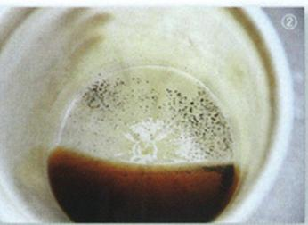
●約30分の放置後、コンプレッサーを使って抜き取った液体。中には大量のカーボンドストが！
