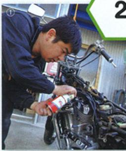
●NC-900RCR（リムーバー）を筒内に直接噴射し、こびりついたカーボンを溶かして浮かせる
