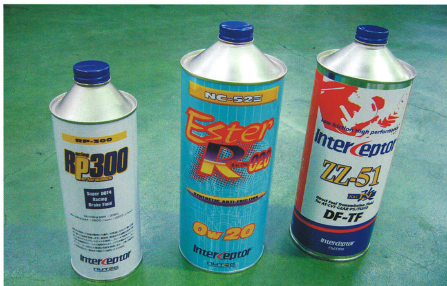
今月はエンジン/ギアボックス/ブレーキの各オイル交換を神奈川トヨタ・マスターワン店で実施した。使用したオイルはいずれもニューテック製で、左からブレーキフルード:RP300(3570円/500ml×2本)、エンジンオイル:NC-52E(3045円/1ℓ×4本)、ATF:ZZ-51改(2730円/1ℓ×6本)の3種類。作業料はエンジンオイル/フィルター交換が1575円、ATF交換が7200円、ブレーキフルード交換が5400円だった。
