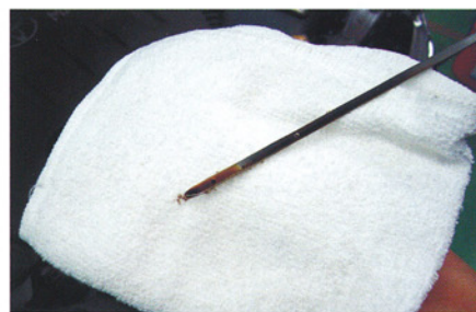
オイル交換から25,798km走行後のエンジンオイル・レベルゲージ。この間の消費量は約700cc。指で触ると粘度を感じさせるオイルは予想するよりもはるかに汚れが少なかった。
