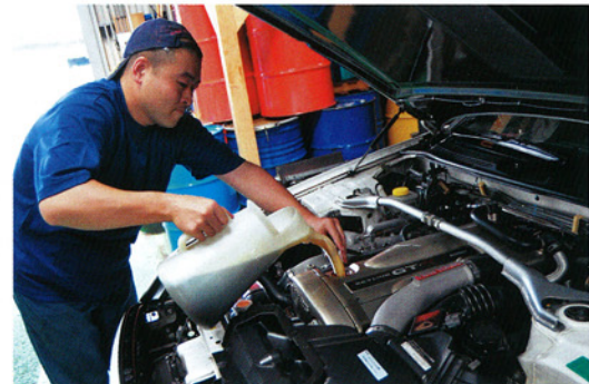
「走行距離が延びれば、オイル上がりが起こり、燃焼室にカーボンがたまりやすくなります。これを何とかカバーしようとして研究した結果、「5W40～50の真ん中」のような仕様を導き出したのです」と鳩谷代表
