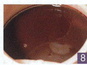
⑧抜き取ったATF。新品時はもう少し澄んでいて、さらさらした感触だった。1年で1万5000kmを走行し、油温も何度か上げたことから、さすがに劣化が進んでいた
