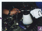
④ちなみにこの工程ではプラグを取り外す必要があるため、エンジンは停止する。1時間程度放置した後、専用ツールで液化したNC-900をプラグホールから吸い出す
