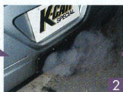
②NC-120注入中は、このようにマフラーのテールから白煙がモクモク。落ちた汚れが排気ガスに混ざって出てくるわけ。当然、この作業はエンジンをかけながら行う
