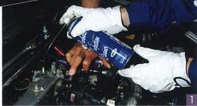
①NC-120インジェクションクリーナーをスロットル直前に差さっているバキュームホースからエンジンへ向けて注入。スロットルなどに付いたカーボン、スラッジを取り除く
