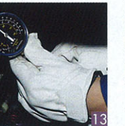
⑬全工程を終え、コンプレッションを確認。結論は表のとおり、4気筒の値がほぼ揃ってしまった。基準値よりも上にあるので、誤差を考えてもコンディションは復活だろう
