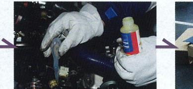
⑪メインイベントともいふべき、圧縮圧力向上剤NC-202の施工。1気筒あたり約10ccの量を注入する。軽くクランクを行い、ピストンリングとシリンダー間になじませる
