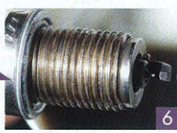
⑥NC-900のこの上ない洗浄力? をこの目で確認するべくプラグの洗浄を試みた。カーボンが完ぺきに取れてしまった
