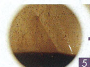
⑤容器の底に見える茶褐色の粒が、エンジン内部に潜んでいたカーボンやスラッジである。編集部のコペンは幸か不幸か、それほど多く抱え込んでいなかった様子
