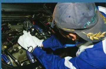
►4気筒すべてのプラグを外し、まずはNo.1シリンダーのプラグホールヘコンプレッショングージを取り付ける。コンプレッショントイド、エンジンのシリンダー内部にかかる圧力を見るためだ。これには自動車メーカーの定める基準値があつて、数字が大きく下回っていれば混合気の一部が漏れている可能性あり
