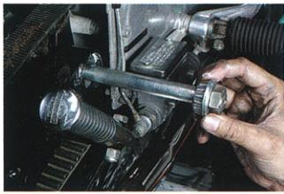
スポーツスターのスイングアームにはテーパーローラーベアリングが使われている。加えてピボットシャフトに水が掛かる構造なので、グリスには高い防錆能力も求められる。
