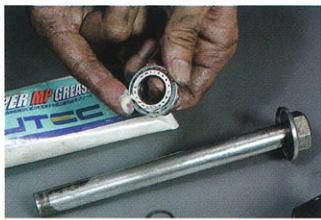
スイングアームピボットのベアリングをグリスアップすることで、リア周りの動きは明らかに良くなる。復元時はサービスマニュアルに示されたトルクで締め付けること。
