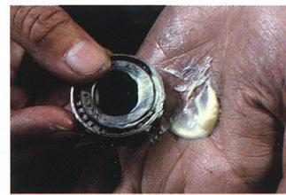
02 きれいに洗浄した手のひらにグリスを絞り出し（ここで異物が混入したら元も子もない）、ベアリングでグリスをこすり取り、表面だけでなくローラーの裏面にも行き渡るように塗布する。
