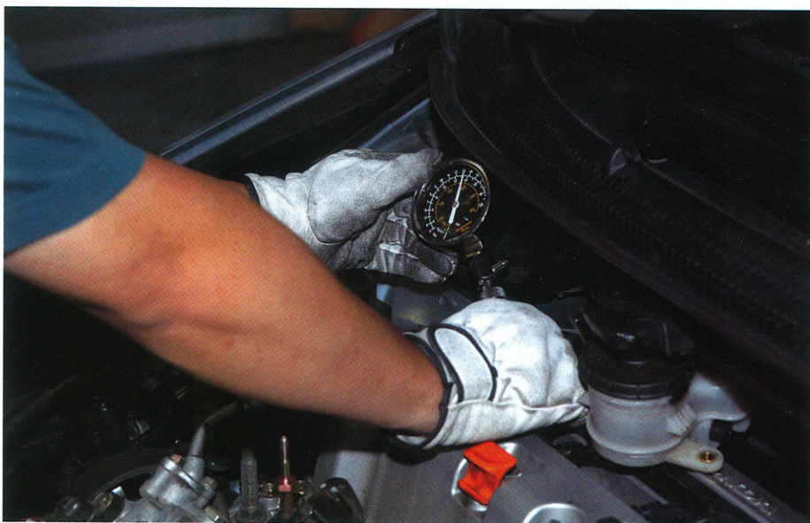
①作業開始前に現状での圧縮圧力がどうなっているかを掴んでおく。CGオデッセイは#1シリンダーが15.8、#2が16.0、#3が15.5、#4が15.6だった。単位はkg/cm 2 で、いわゆる圧縮比と異なるのは言うまでもない。スターターをチョンチョンと回してクランキングしながら計測する。コーティング施工後は果たせるかな、同16.2、16.5、16.2、16.6と4気筒すべてが着実な上昇をみたのが嬉しい。
