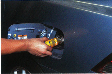
②ついでにフェューエルラインの掃除をしておく。燃料タンクに溜まったスラッジを除去。
