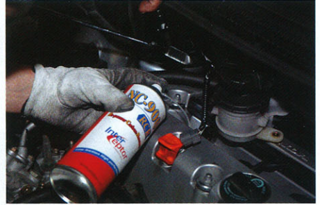
④これからが本番。まずムース状のリムーバーをプラグ孔から燃焼室に向けてスプレーし、1時間ほど放置すると隅々まで行き渡ってカーボンを溶解・剥離、やがてそれを包み込んだ形で液化する。
