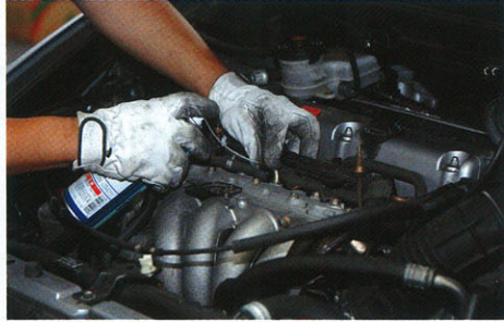
③これもその一環で、EGRの途中からクリーナーを注入し、インジェクターのノズルをクリーニングする。
