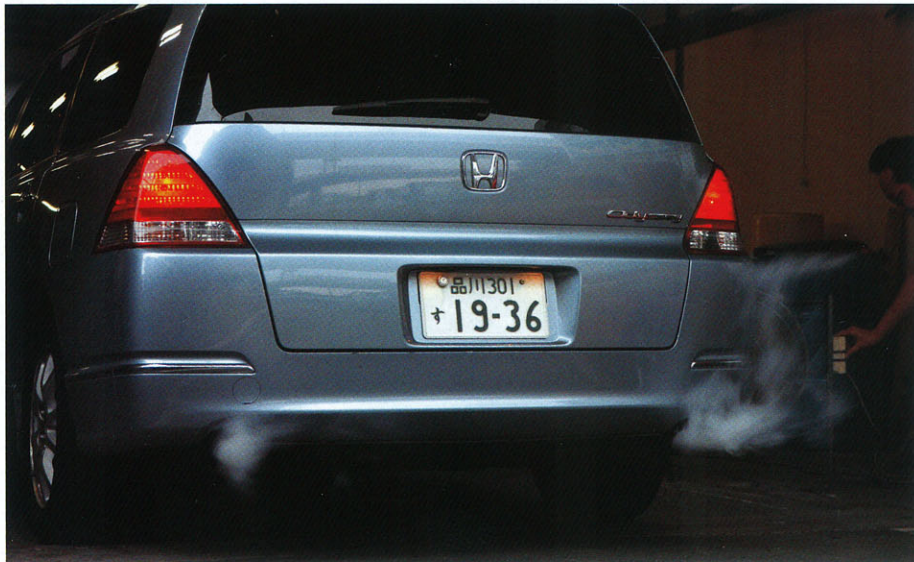
⑦ここで一旦エンジンに火を入れてやると、テールパイプから今まで見たこともないような白煙と刺激臭が吹き出されてビックリする。残りのカーボンと溶剤が燃えて排出されたのだ。換気のために車の脇でファンを回しており、実際には辺りが霞んで見えるほど大量に出る。ちなみに、それらは触媒が作動温度に達してさえいれば燃え尽きるので問題はないという。
