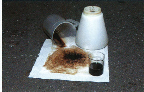
⑥真っ黒になったその溶液を濾過してみると細かな粒状になったカーボンがこれだけ確認できた。11万5000kmの垢というわけだ。
