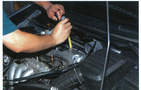
⑨最後にコーティング剤を注ぎ込む。2.4ℓクラスなら気筒当たり10cc程度。基本的にはエンジン稼働時の熱と爆圧で定着するが、より厳密には少々慣らしが必要で、そのため施工後は距離にして50kmくらいの間、穏やかに走る事が求められている。
