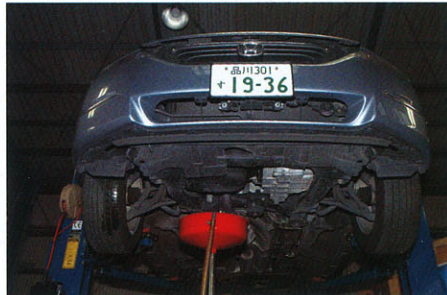
⑧エンジンオイルを下抜きでドレイン。NUTEC Japanオリジナルの“Interceptor”オイルはオデッセイの場合、0W-30の“NC-51 Ester R”を使った。下周りもキレイなものでしょ？
