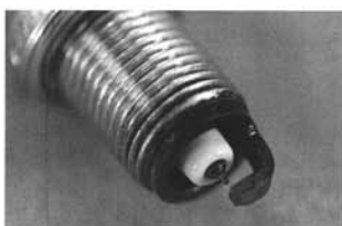
注目はプラグの先端の汚れ。火花が発生する部分だけに、この汚れは燃焼状態に大きく影響する。寒い日の朝、エンジンが元気づく目覚めるようになること間違いなしだ。
