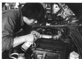
プラグ穴から細いホースを差し込んで施工液を注入。面倒なのが、クランクを回して上死点を合わせるところだ。
