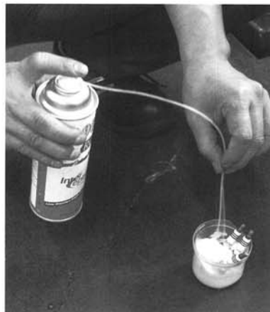
注目はプラグの先端の汚れ。火花が発生する部分だけに、この汚れは燃焼状態に大きく影響する。寒い日の朝、エンジンが元気づく目覚めるようになること間違いなしだ。
