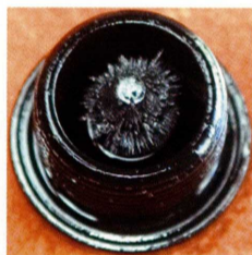
ドレンボルトに付着した鉄粉。2万km走行ゆえこの程度の量は妥当か。一方、トランスファーオイルの劣化はやや大きかった。時折サーキットや峠でのタイヤテストなどでの酷使が響いた!
