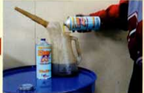
規定量はフィルター交換時で4.4ℓになるJTSの2ℓエンジン。フィーリング報告などは次号で。 NC-50とNC-51を50:50でブレンドし、10W40の設定に調整。こうしたアレンジが可能なのも特徴。
