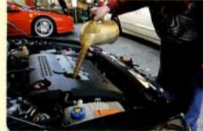
規定量はフィルター交換時で4.4ℓになるJTSの2ℓエンジン。フィーリング報告などは次号で。 NC-50とNC-51を50:50でブレンドし、10W40の設定に調整。こうしたアレンジが可能なのも特徴。
