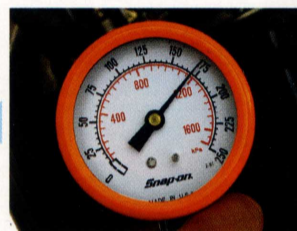
右がNC-202施工前の1番シリンダーの圧縮圧力で11.6~11.7辺り。対して左の施工後は12.1まで向上。施工直後にも関わらず他のシリンダーも同様にアップ。NC-202注入後は最低でも100km程回転を上げず慣らしを行い、しっかりコーティングさせるのが原則だ。
