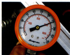
右がNC-202施工前の1番シリンダーの圧縮圧力で11.6~11.7辺り。対して左の施工後は12.1まで向上。施工直後にも関わらず他のシリンダーも同様にアップ。NC-202注入後は最低でも100km程回転を上げず慣らしを行い、しっかりコーティングさせるのが原則だ。
