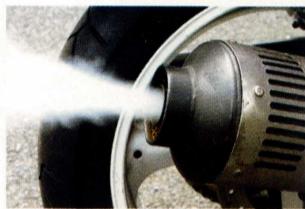
少々馴染ませた後、プラグを装着しエンジン始動。白煙がもうもうと出るが、ケムリの出具合が落ち着くまでアイドリングさせておく。
