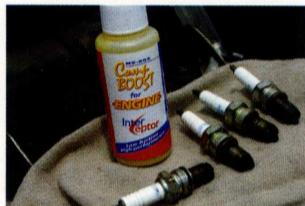
白煙が止まったら、プラグを新品に交換。NC-202がプラグまでコーティングして、そのままでは失火しやすい状況になるからだ。
