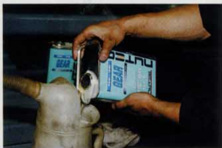
75w-90のNC-70と80w-140のNC-71を3:1でブレンドし、348に投入。帰りの道では早くもシフトフィールが軽くなったことを体感できた。さらにオイルが馴染んでくれば……。
