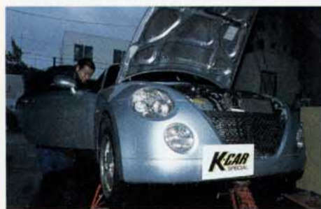
↑ジャッキアップしてエンジンを始動、Dレンジに入れてZZ-51を循環させる。その後、少し抜き取り、ZZ-51をその分注入。これを繰り返して交換完了
