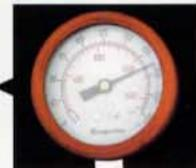
コンプレッションゲージを用いて、圧縮圧力を測る。まずは施工前の状態を測った。一般的にはこの数字が良い部類だが、もともと圧縮アップチューンが施されているので、このような数字なのだろう。
