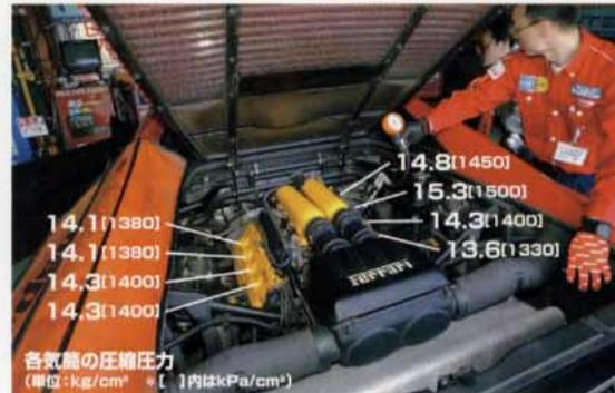
フェラーリ348tbのV8エンジンは、NAユニットとしては、もともとハイチューンのエンジンだが、取材車にはそれをさらにチューニングしたエンジンが搭載されている。ガスケットの交換により圧縮比が高められているため、単純に圧縮圧力を計測すると、思ったよりも低い数
