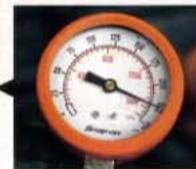
NC-202の施工後に再び計測すると、なんと各気筒とも大幅に圧縮圧力アップ。平均1.4kgも圧縮圧力が上がってしまった。ヤれていたということの裏返しだが、この圧力の上がり方は驚異的。
