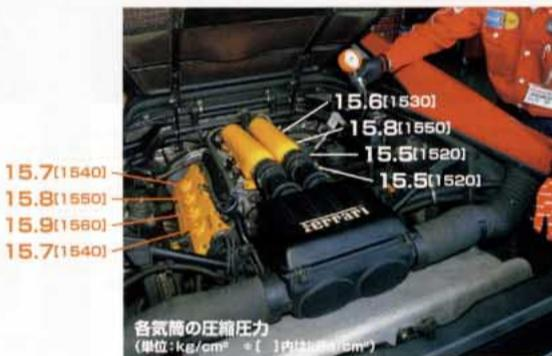
施工後に計測すると、どの気筒も大幅に圧縮圧力が上がっているのが確認された。やはりハイチューンエンジンを過激に使うと、走行3万kmでもかなりエンジン内部がヤレしてしまうのだろう。また施工前の圧縮圧力には大きなバラツキがあったが、施工後、そのバラツキの度合い
