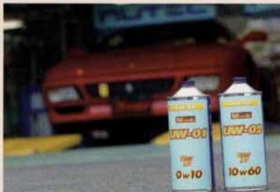
今回、UW-01とUW-02は40:60で混合したが、例えばジムカーナなど低速走行なのにエンジンは高回転まで使用するといった使用条件では、UW-02の比率を高くしてもいい。もし短いコースなら、逆にUW-01の比率を高くしてレスポンスアップという使い方もアリだ。
