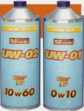
サーキット使用が多いことや、ハイチューンエンジンであることから、ブレンド比率はUW-01を40%、UW-02を60%とした。粘度はおおむね5W-40。高温粘度は純正指定と同じだが、ベースオイル自体が金属に吸着する性質をもつエステルを多く含有するため、たとえもっと低粘度の設定でも油膜強度は一般的なオイルより高い。さらに40という粘度によっても油膜強度を上げており、ダブルで油膜保持＆潤滑能力をアップさせている。低温粘度が低いので、スターターも軽くまわり、冷間時のエンジンの負担が少ない。つまり使用全般としてはよりフリクション軽減、高温高負荷時はさらに油膜強度アップ、という設定なのだ。
