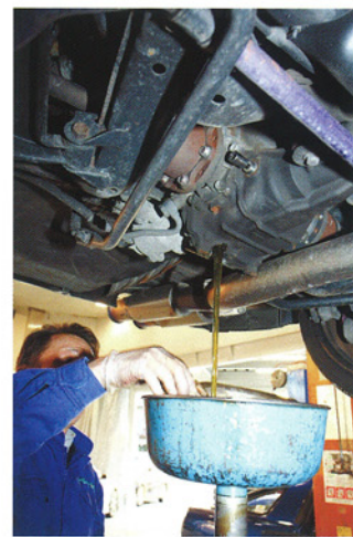
リヤデフもミッションと同時期に交換している。汚れているわけではないが、長距離移動が多いためミッション同様に劣化が見られた
