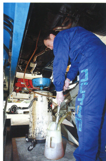
今回投入したのはNC-70。BCNR33のトランスミッションには約3.5ℓは用意しておきたい。投入後はシフトフィールに程よい手応えを感じた!
