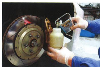
高性能社外ブレーキキットにおいても性能の違いを感じた。おそらく純正キャリパーでも体感できるはずだ。パッドより先にフルード交換をせよ!
