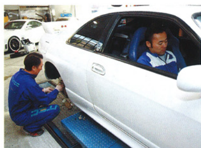
ブレーキフルードの交換作業は基本的に二人で行う。 DIYでの作業も可能だができることならプロに任せたい
