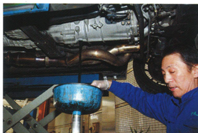
発熱量の多いRB26とつながっているだけに、熱による被害をかなり受けやすい。ミッションオイルは昨年の7月に交換しているが、半年間の仕様ながらかなり黒ずんでいた
