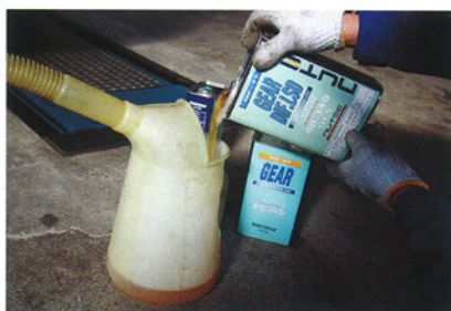
ギヤオイルもエンジンオイル同様ブレンドは可能だが、トランスミッションには何もせず、そのまま投入することにした。デフとミッションは同じオイルを使用することに
