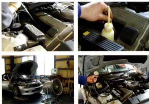
左上 | スパークプラグ穴からスパークを外す。右上 | スポイトを使って、スパークプラグ穴に直接注入。左下 | ダイナバックで実際に効果があるのか測定してみました。右下 | 圧縮圧力もほぼ1.5kg/cm 2 ほどアップ。
