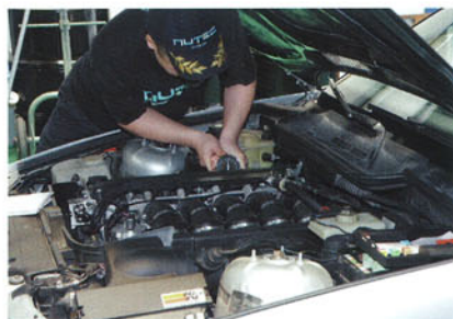
▲圧縮圧力を計測すると施工前各気筒バラバラだったところがピタリと合う。オイル交換をしても効果が落ちることはない。
