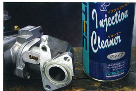
アドレスV125は、冷間時にアイドルリングが不安定になる傾向がある。これはアイドルポートにスラッジが溜まりやすいが原因。そんなとき、NC-120キャブレター&インジェクションクリーナーがかなり役立つとか。
