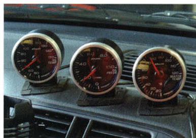
油温が75℃になったところで全開、測定開始だ。測定時には最大限に出力が得られる適正な80℃の油温になる寸法
