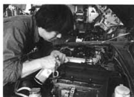
プラグ穴から細いホースを差し込んで施工液を注入。面倒なのが、クランクを回して上死点を合わせるところだ。
