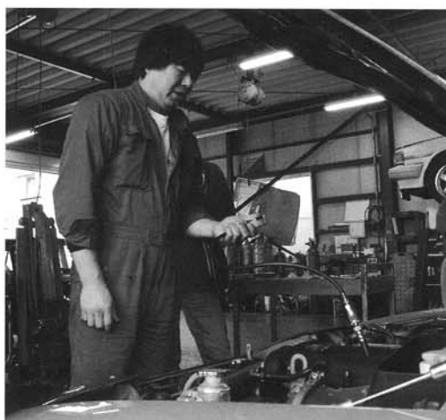
プラグ穴から細いホースを差し込んで施工液を注入。面倒なのが、クランクを回して上死点を合わせるところだ。
