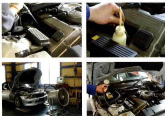
左上 | スパークプラグ穴からスパークを外す。右上 | スポイトを使って、スパークプラグ穴に直接注入。左下 | ダイナバックで実際に効果があるのか測定してみました。右下 | 圧縮圧力もほぼ1.5kg/cmほどアップ。
